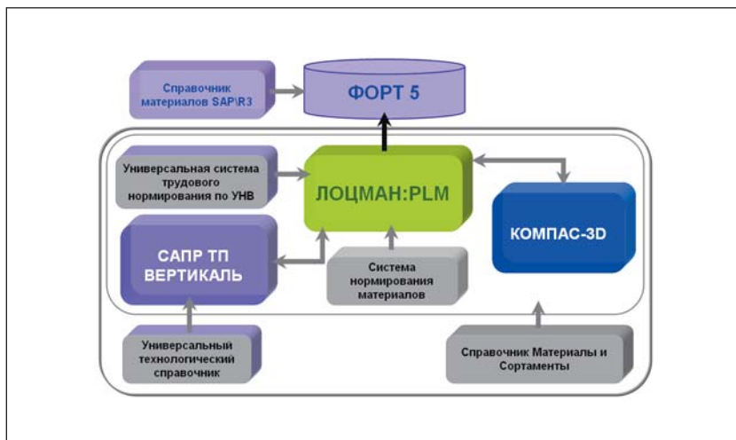
Рис. 2. Укрупненная схема информационных потоков в программном комплексе автоматизации БМЗ
